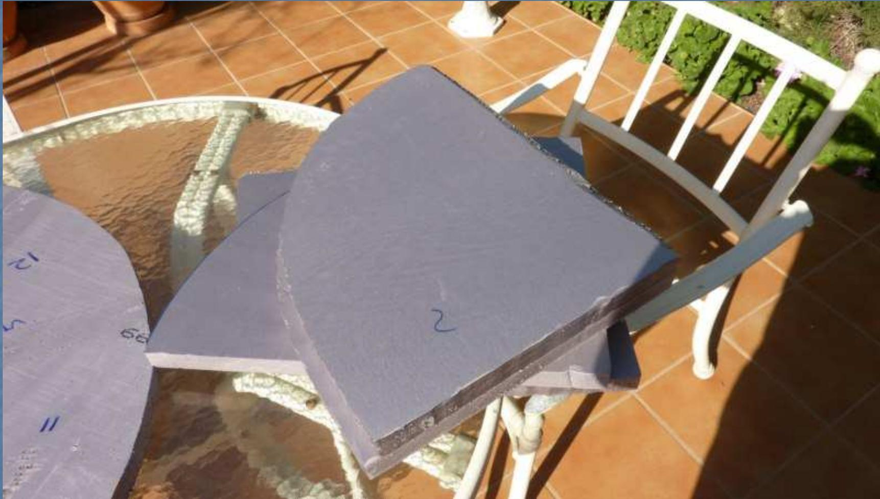
Las he cortado con un radio de 40 cm, (nota, no hice la curvatura completa, ya que desde la base deje unos 15 cms (tres ladrillos) recto, y luego continúe la curvatura) ya que si las cortara de 45 sólo podría colocar dos juntas, las otras dos saldrían por los bordes 5 cms, con las fotos siguientes lo entenderéis.
