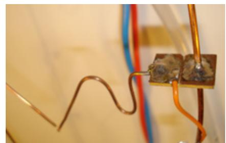
arriver : le coté cuivre est séparé en deux par des coups de cutter. Une moitié servira à se souder au cadre (par un trou traversant par exemple), et l'autre moitié supportera le demi V, ainsi que le fil de connexion vers l'électronique.
